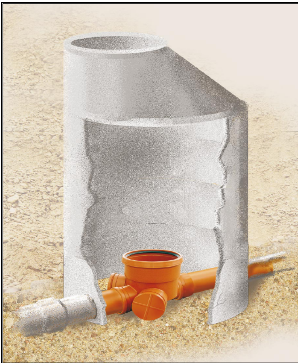
Образец применения кинеты из полимерных материалов методом релининга.
